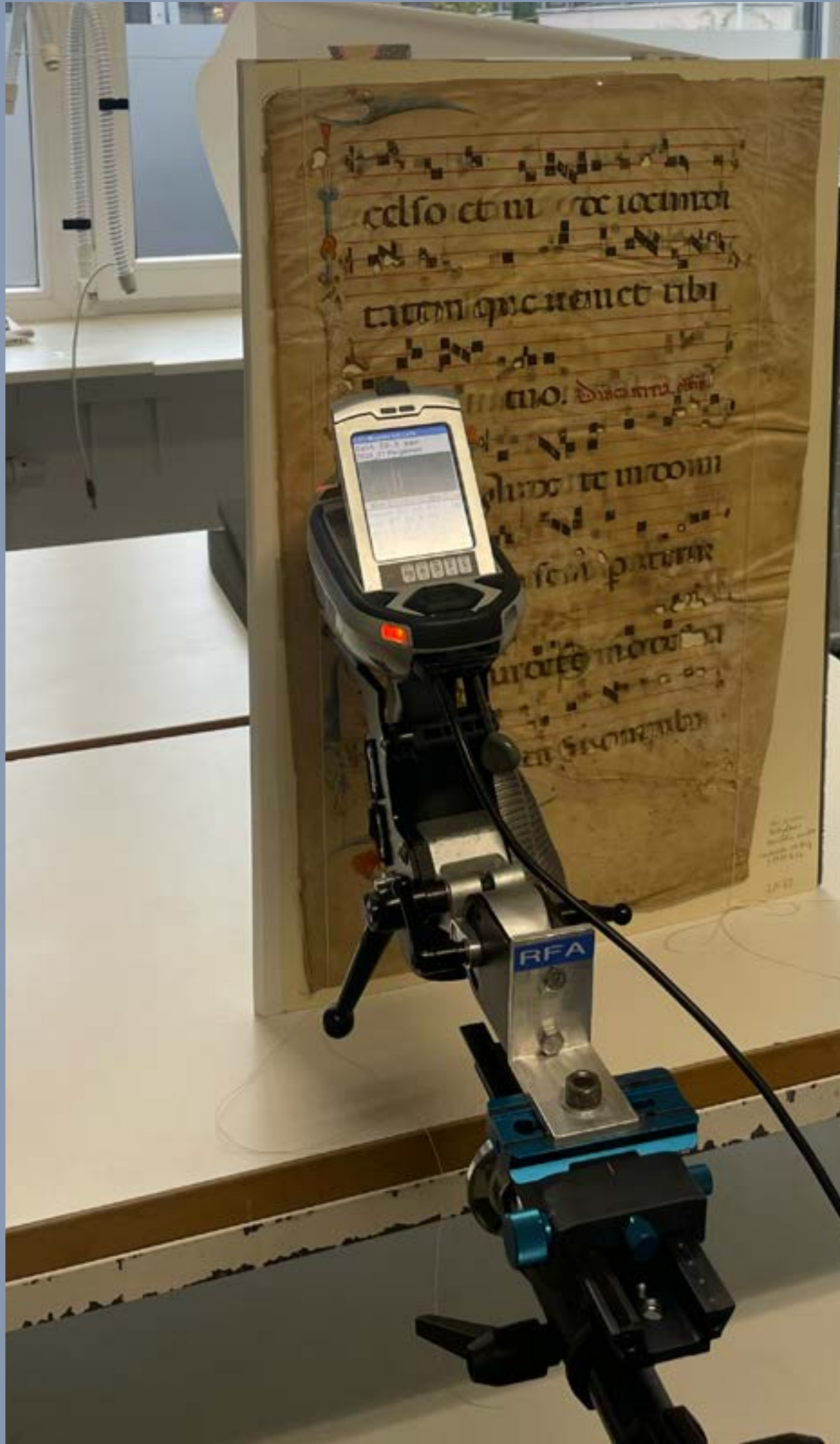
Abb.10: RFA Durchführung am Blatt Eigene Aufnahme
